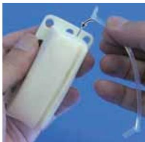
Inserta uno de los extremos del anillo de silicona en una abertura del extremo de la base del radio de tal forma que el nudo quede por debajo de la base.
