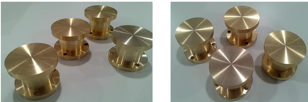
Figura 2: Soportes adaptativos para elevar la posición de trabajo y sujetar la pieza.
