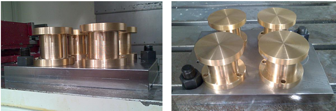
Figura 4: Configuración de 4 posiciones de trabajo (1, 2, 3 y 4).
